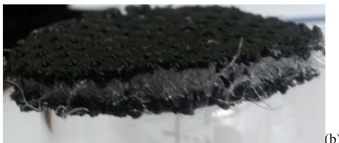
Fig. 3.14 Materialul S3D înainte (a) și după (b) impact (test T12)
