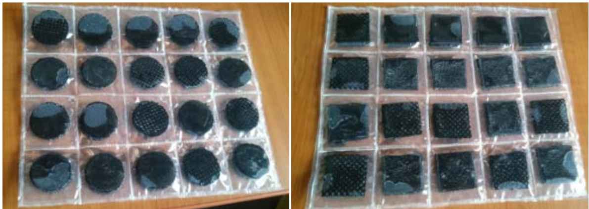
Fig. 2.8. Matrice de protecție liniară cu celule disc (stânga) sau pătrate (dreapta)
