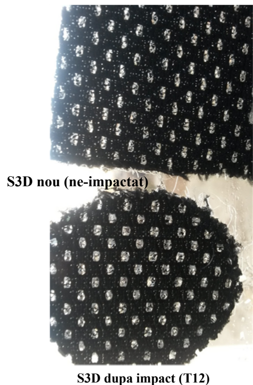
Fig. 3.15 Materialul S3D înainte (a) și după (b) impact (test T12)
