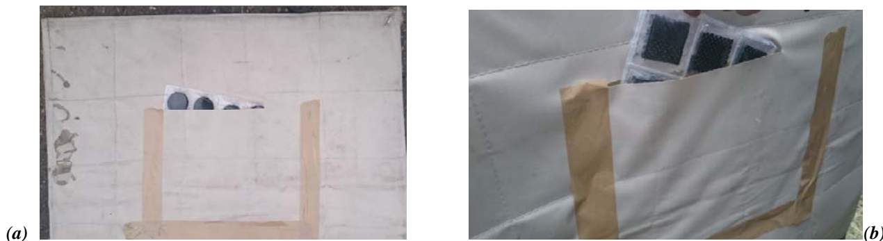
Fig. 2.12. Vestea de protecție. (a) - integrarea matricei cu celule disc. (b) – integrarea matricei cu celule pătrate
