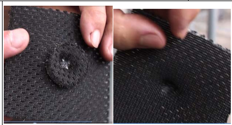
Fig. 3.6 - 2 straturi S3D, uscate, sudate dupa impact fara strat intermediar (față-stânga - spate-dreapta)
