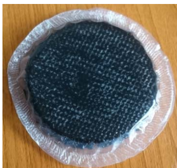
Fig. 1.1 Celula de amortizare S3D + glicerină cu zeosil
