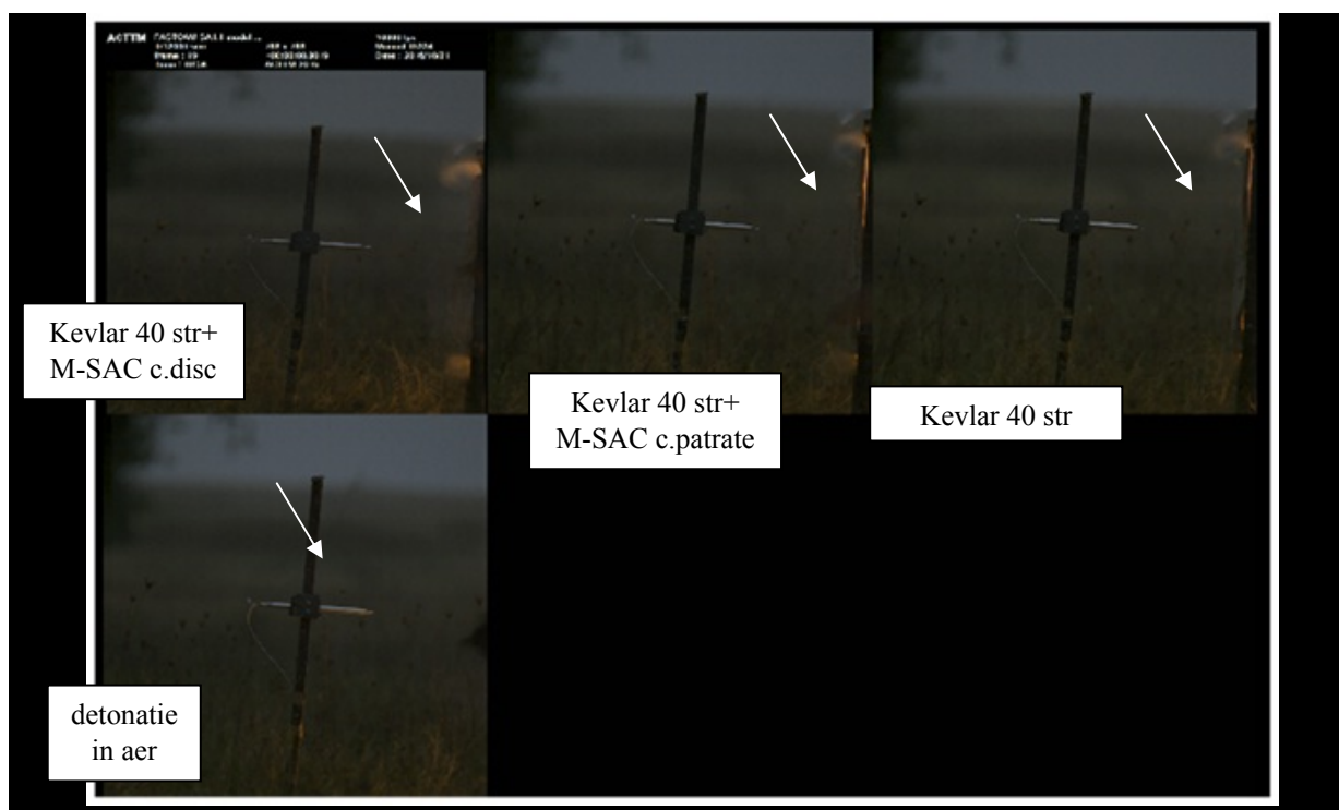
Fig. 4.3 Filmare rapidă a undei de șoc generate de încărcătura de trotil. Sunt prezentate comparativ în același moment de timp deplasările undei de șoc pentru cele 4 teste comparative.
