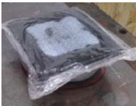
Fig. 1.2. Pastă dispersată în tot materialul poros
