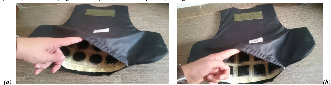
Fig. 2.12. Vestea de protecție. (a) - integrarea matricei cu celule disc. (b) – integrarea matricei cu celule pătrate
